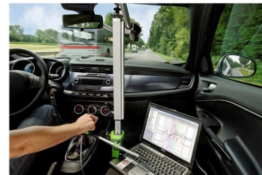
Система измерения и оценки свойства переключения передач автомобиля
